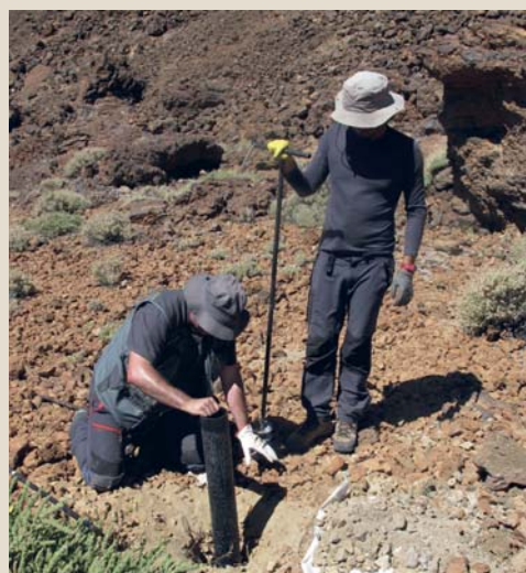
Instalación del tubo en el acúmulo de piroclastos, recolocando ordenadamente los materiales extraídos con cuidado de no alterar el entorno.
