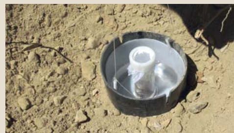
Introducción de la cazoleta en el tubo previamente cargada con cebo y líquido conservante.
